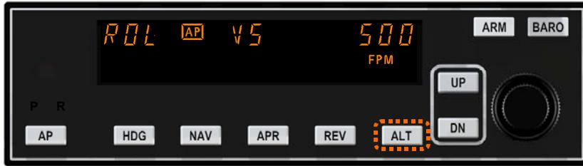
Fig. 23. Vertical Speed Mode
